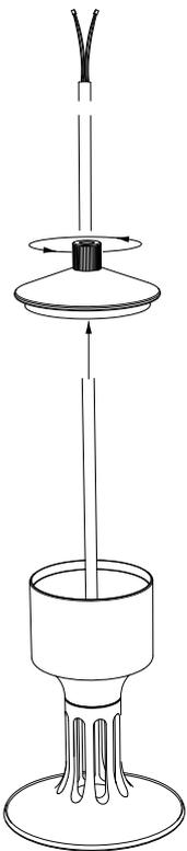
1. Öffnen Sie das Rändel durch Drehung gegen den Uhrzeigersinn. 2. Ziehen Sie das Pendelkabel nach unten aus dem Deckel. 3. Führen Sie das Glas über Kabel und Korpus. 4. Schieben Sie das Pendelkabel wieder durch den Deckel.
